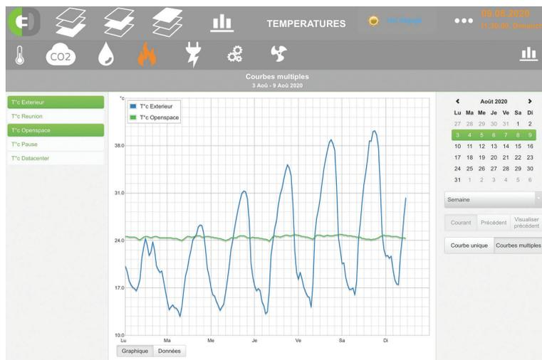
**Le rafraîchissement par géocooling dans les sondes fonctionne puisque la température dans le bâtiment est restée constante malgré les fortes chaleurs extérieures.**
